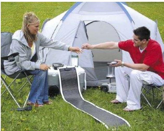
8. kép: Szőnyegszerű, hordozható, hajlékony napelem (Forrás: www.urvilag.hu )
