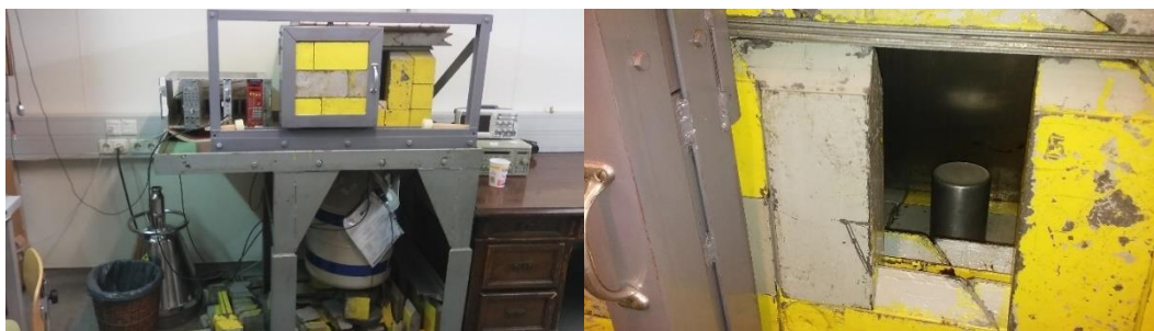
13-14. ábra: Balra látható az ólmotorony, jobbra pedig a HPGe detektor, aminek a közepére helyeztük a mintát.
