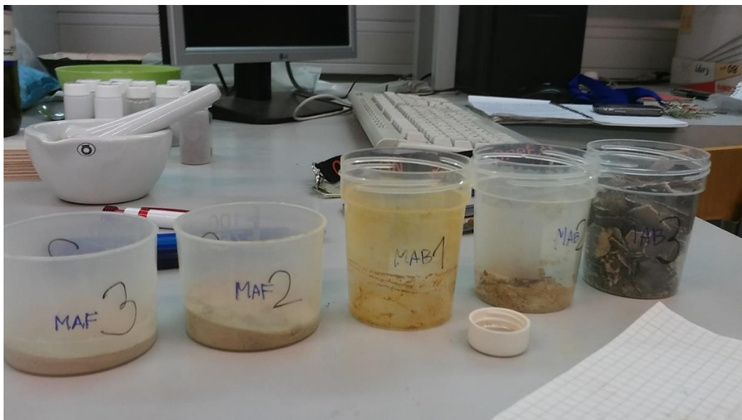
8. ábra: A bevonat- és falminták. Látható, hogy a MAB minták heterogének, a MAF minták homogének. A középen látható MAB1 mintatartóából történt a kaparási vizsgálat.
