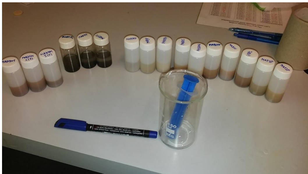
12. ábra: Az exhalációs mérésre előkészített minták, szcintillációs koktél nélkül.
