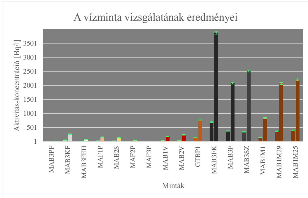
27. ábra: A 2017. május 17-ei (első oszlop) és 23-ai (második oszlop) mérések eredményei. A színek a mintaszínekre utalnak.
