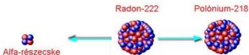
1. ábra: ^{222}\text{Rn} bomlása ^{218}\text{Po} -ra (Forrás: guides.bestchamber.com)
