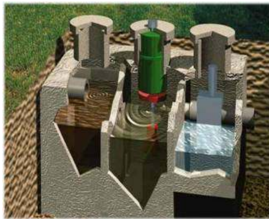
12. kép: Házi szennyvíztisztító berendezés felépítése
