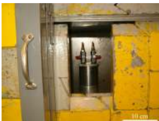
8. ábra A HPGe detektor és ólomtorony, egy mintatartó kamrával vizsgálat előtt
