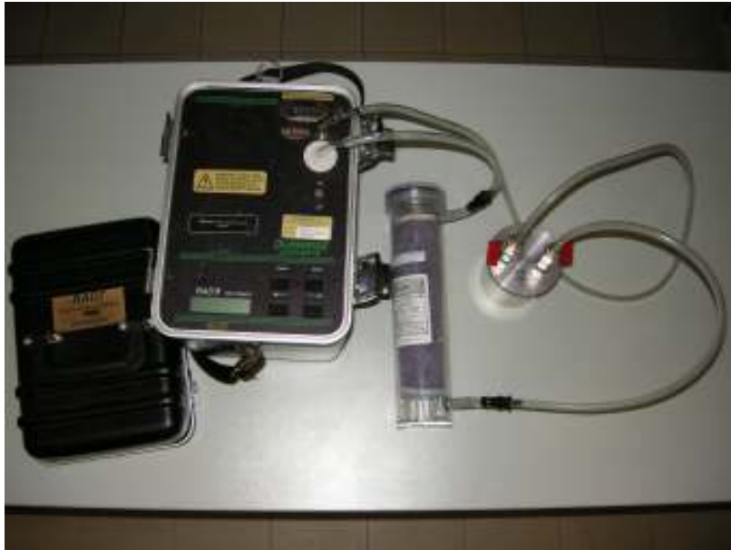
12. ábra A radon-exhaláció mérési elrendezése. Balról jobbra: RAD7 detektor, páralekötő egység, radonkamra, műanyag csővel összekötve
