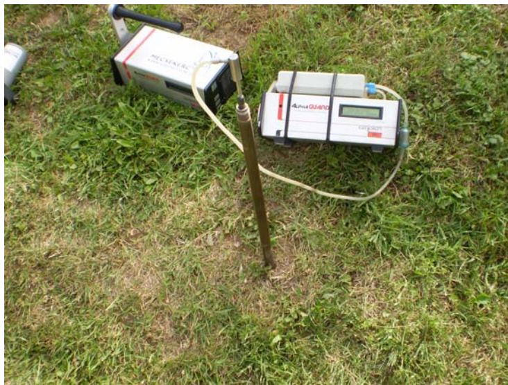
7. ábra: Talajgáz radonaktivitás-koncentrációjának meghatározására használt AlphaGuard radonmonitor és a hozzátartozó talajgáz szonda mérési összeállítása
