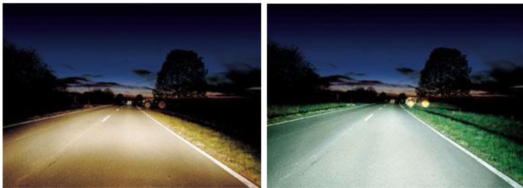
Xe-2. ábra A hagyományos és a Xenon izzók fényének összehasonlítása Forrás: (2012.04.28) http://www.blog_eppen_ami.abbcenter.com/?id=9028#
