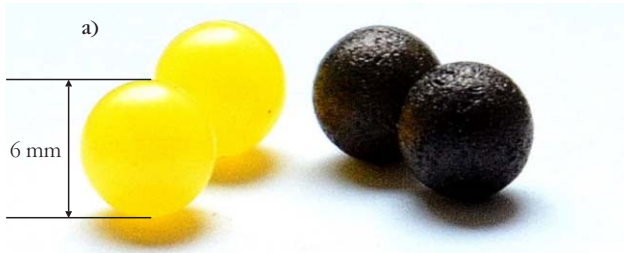
4. ábra. a) A kísérletekben használt műanyag (airsoft) golyók érdesítés előtt és után. b) Az érdes és a sima golyókból képzett „homokdomb” felületén mérhető rézsűszögek eloszlási görbéi. A két komponensre az átlagos rézsűszög 23,4^\circ , illetve 19,2^\circ -nak adódik.
